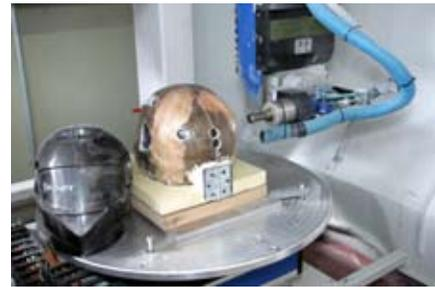
Complejo robot con el que se realiza un milimétrico trabajo de perforación y recorte en las carcasas de los cascos.
