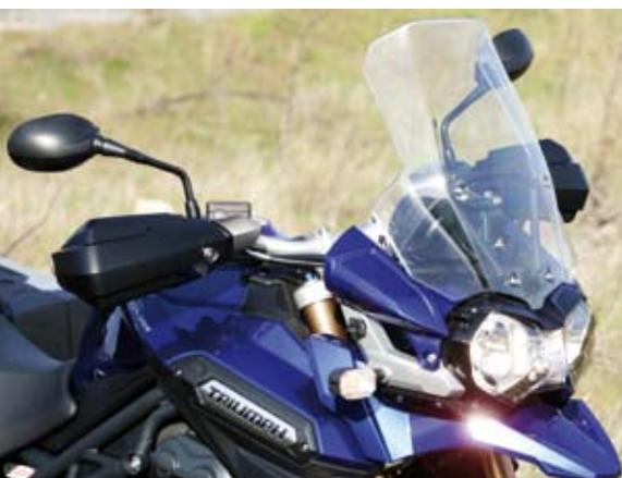
Su frontal, con pantalla regulable en altura, es uno de los puntos destacables de la 'british'.
