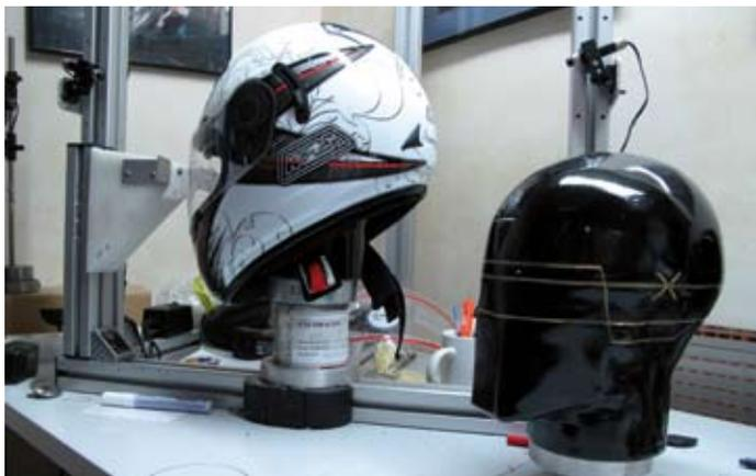
Prueba de calibración de impacto. Mediante un láser, se comprueban los daños sufridos en diferentes partes de la carcasa.
