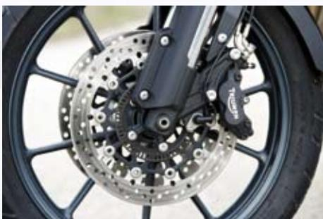
Probado en pista deslizante, el ABS (desconectable) de la Triumph funciona a la perfección.
